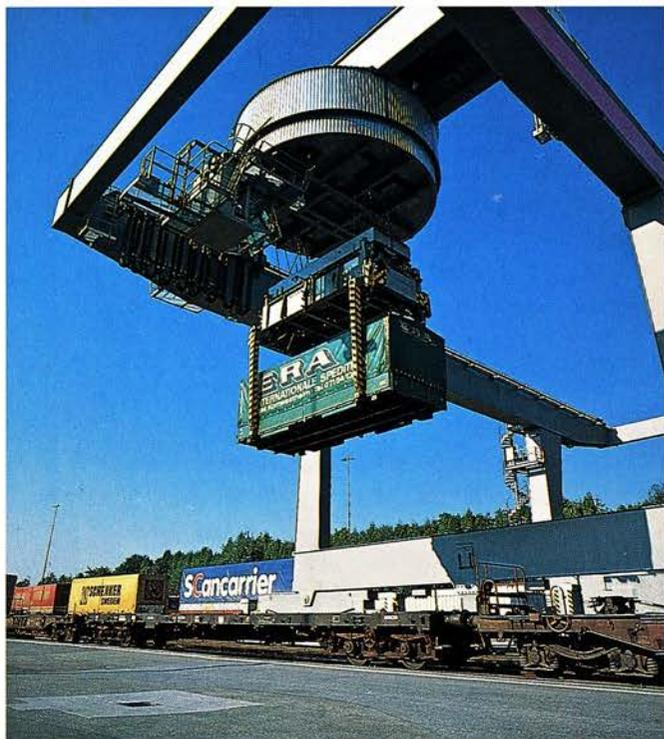
Wechselbehälter werden im Huckepackverkehr mit einem Kran umgeschlagen. Hierzu ist das Krangeschirr mit vier Greifzangen ausgerüstet, die den Wechselbehälter an vier Greifkanten (je zwei auf jeder Längsseite) anfassen, vom Lkw abheben und auf den Waggon umladen.
